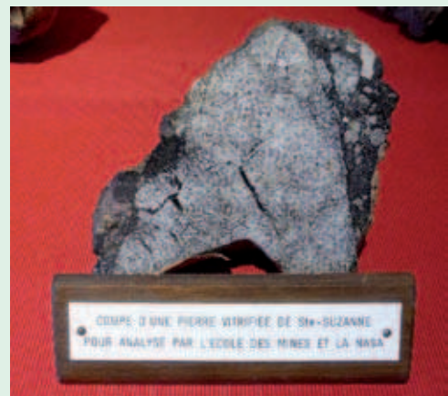
Fig. 10. – Echantillon de grès-quartzite englobé dans du verre sombre, scié pour étude pétrographique (NASA et Muséum). (Musée de l'Auditoire).
